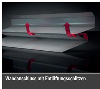
Abb. 8 Ein hinterlüfteter Wandanschluss sorgt für den nötigen Luftaustritt, damit sich die Kondensatwasserbildung verringert.
