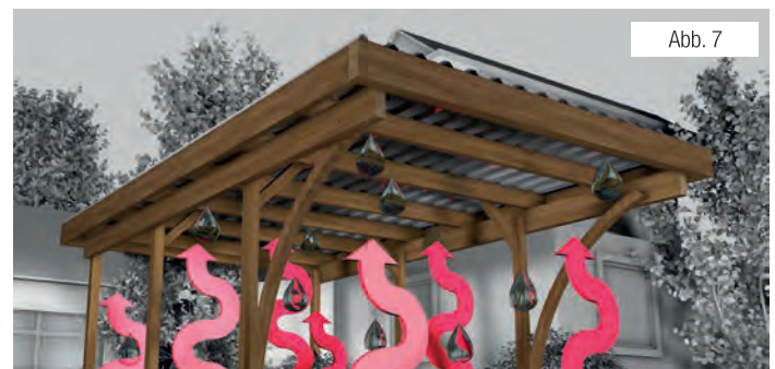
Abb. 7 Feuchtigkeit steigt nach oben und bildet Kondenswasser, das ohne richtige Lüftung von dem Dach abtropfen kann. Deshalb muss für ausreichend Luftstrom gesorgt werden.
