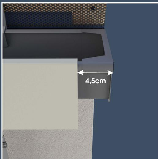
Montieren Sie das Abdeckprofil etwa 4,5 cm vom Ende der Dachrinnenkante entfernt. Bitte behalten Sie die Schutzfolie während der Montage drauf.
