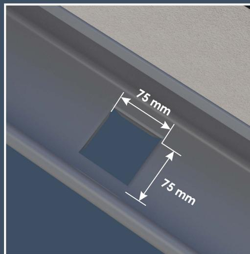
Für das zukünftige Abflussloch sollte die Aussparung die Maße 75x75 mm haben. Entgraten Sie die Schnittkanten und nutzen Sie bei Bedarf Ausbesserungsfarbe, um einen optimalen Schutz zu gewährleisten.
