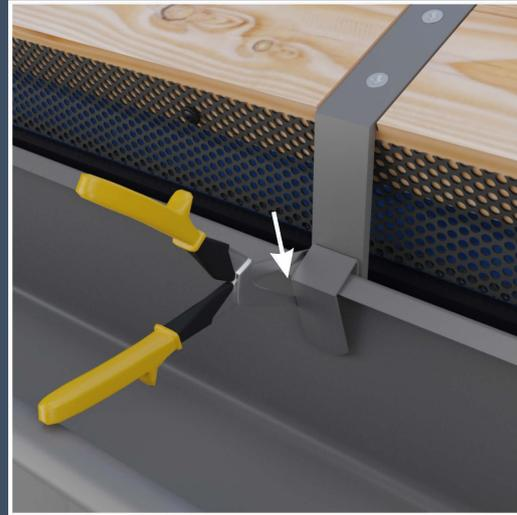
Erzeugen Sie den Spreizankerpunkt, indem Sie mit einer Blechschere auf beiden Seiten des Rinnenhalters die hintere Kante der Rinne einschneiden. Der Fixpunkt des Rinnenhakens halbiert die Dehnungsfuge.
