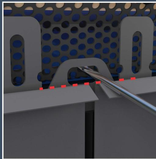
Ziehen Sie den Beschlag fest, sodass die Unterkante der Öffnung bündig mit der Hinterkante der Rinne abschließt. **Achten Sie darauf, den Verbinder nicht zu stark anzuziehen, um unerwünschte Verformungen zu vermeiden.**
