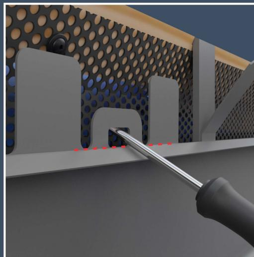
Die Blechelemente an der Kante des Ablaufstutzens sollten festgezogen werden, sodass die Unterkante der Öffnung bündig mit der Hinterkante der Kastenrinne abschließt. Achten Sie darauf, den Stützen nicht zu stark anzuziehen, um Verformungen der Dachrinne zu vermeiden.
