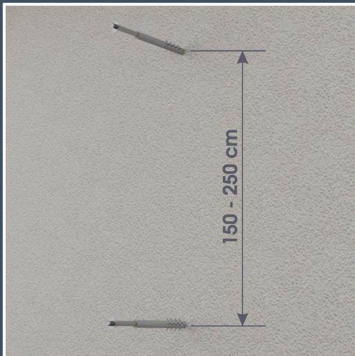
Achten Sie darauf, dass der Abstand der Schrauben für das zu montierende Fallrohr nicht größer als 150 bis maximal 250 cm ist und jeder Rohrabschnitt mit mindestens 2 Schellen befestigt werden muss.
