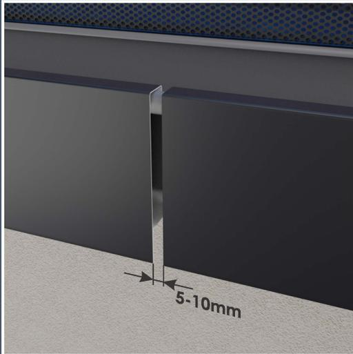
Bei der Verbindung der Abdeckprofile ist es wichtig, eine Dehnungsfuge von 5-10mm einzuplanen.
