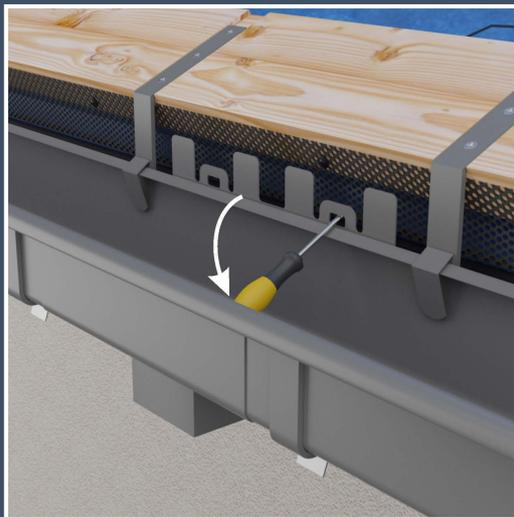
Verwenden Sie einen Schraubendreher als Hebel, um den Blechstützen an der Regenrinne anzupassen und optimal einzustellen.
