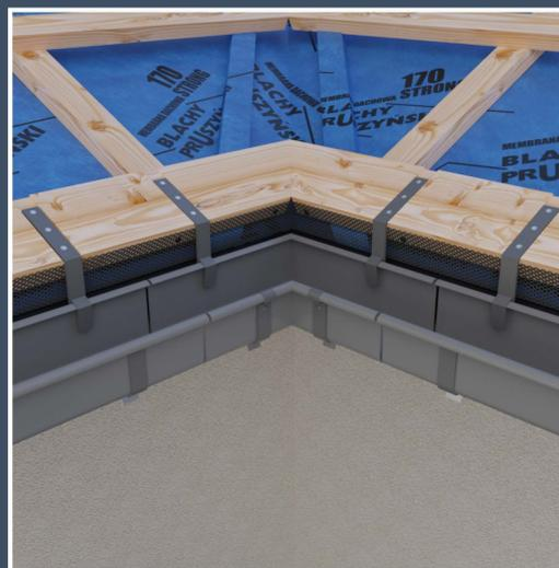
Das Eckstück der Kastenrinne wird in die Rinnenhalter eingehängt und die Metallzungen umgebogen, um eine optimale Fixierung zu gewährleisten. Achten Sie auf eine Dehnungsfuge von 5-10 mm beim Verbinden mit dem nächsten Rinnenelement.
