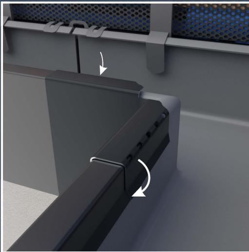
Umbiegen des Falz des Endstückes für Abdeckprofile um die Rinnenkante.
