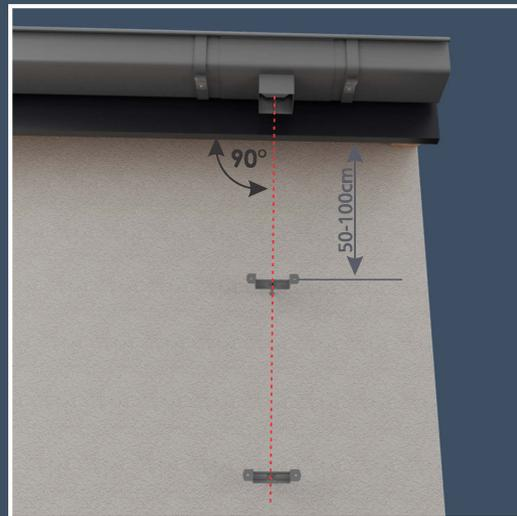
Das erste Blech für die Fallrohrhalterung sollte 50-100 cm von der Überdachung entfernt sein. Das Fallrohr senkrecht und parallel zur Wand verlaufen lassen. Achten Sie auf einen 90°-Winkel vom Ausgang des Ablaufstutzens zur Traufe.
