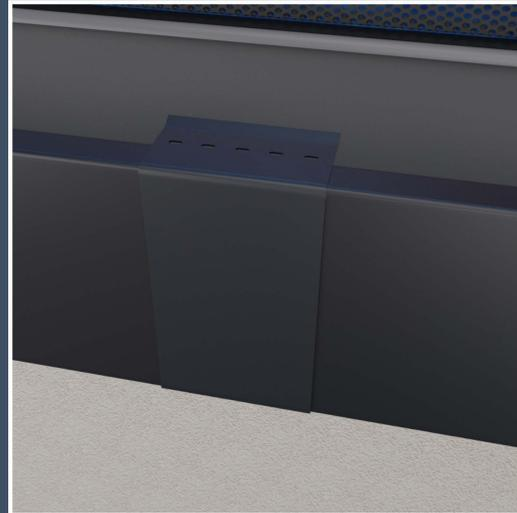
Das Verbinderprofil wird nun über die Dehnungsfuge gelegt und eingehakt.
