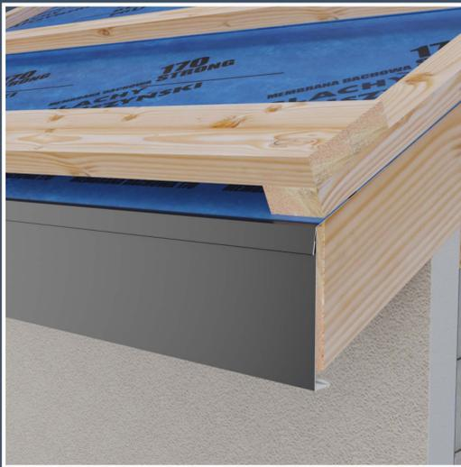
Erstellen Sie die Unterkonstruktion gemäß Montageanleitung für die Dacheindeckung. Für die Latten und Konterlatten empfehlen wir ein Maß von 40x60mm zu verwenden.
