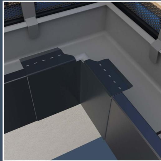
Aufsetzen des Endstückes für Abdeckprofile.
