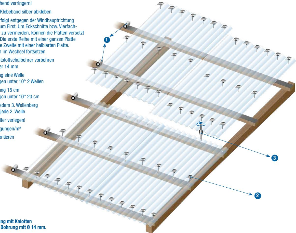
• Erfolgt die Verlegung mit Kalotten empfehlen wir die Bohrung mit Ø 14 mm.
